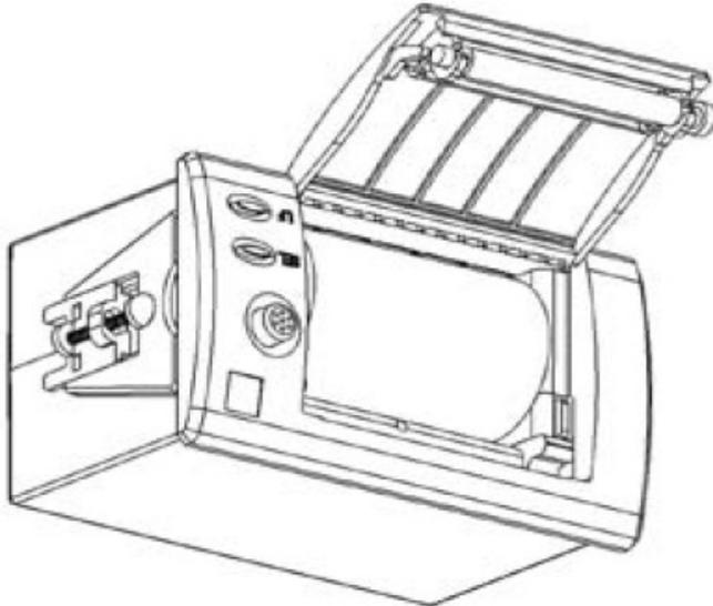
2. Colocar el rollo de papel asegura que se desenrolla en la dirección correcta.
