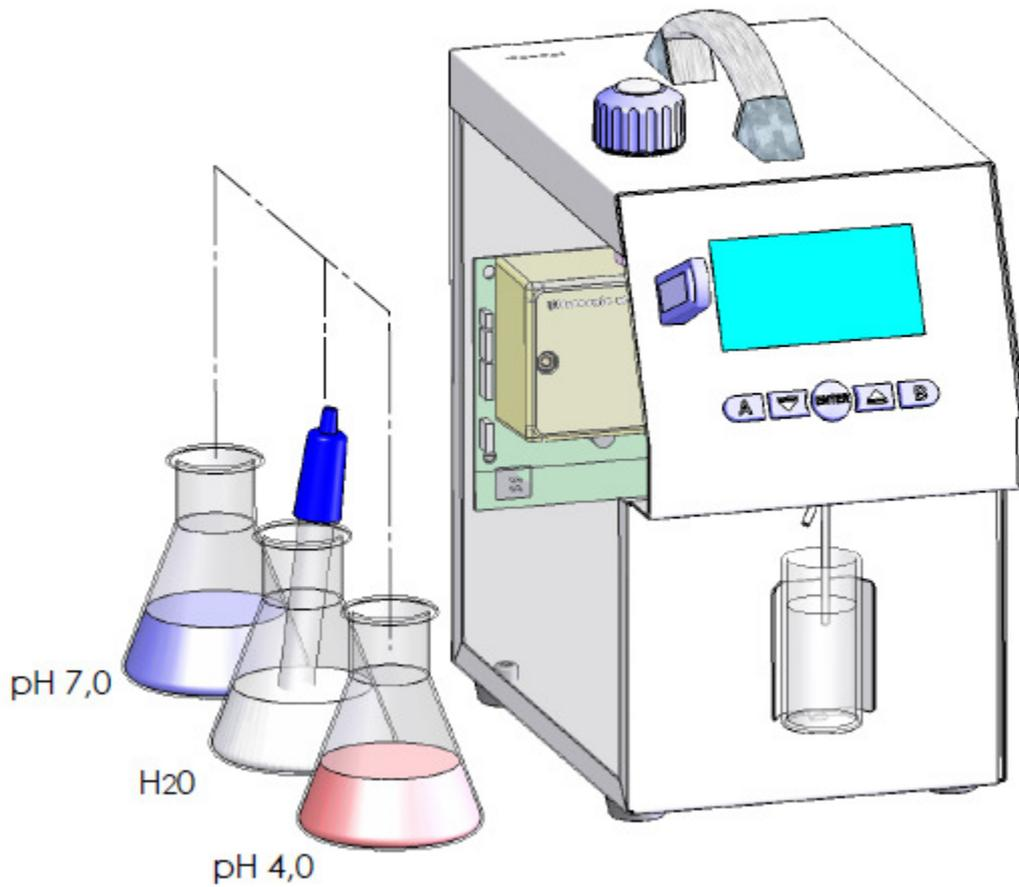
Retire el sensor. Es posible que usted no puede poner la tuerca por que el analizador no succiona durante la calibracion.
